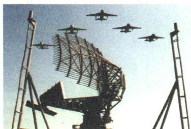
(a) 雷达与“倒车雷达”的原理相似,但它利用的是电磁波。借助雷达,可以发现军事目标
