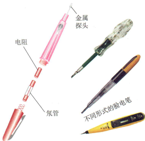
图 9-1-7 常见的验电笔前端为金属探头,后端为金属挂钩或金属片,中间绝缘管内装有发光氖管、电阻及压紧弹簧
