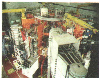
图 11-5-5 JET 可控核聚变装置
