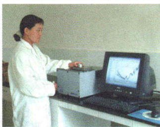
(b) 分析化学实验中，用光谱仪根据各种电磁波谱线的位置和强度，检测某种物质中含有哪些元素
