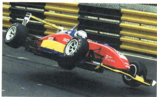
图 7-4-8 赛车车身很低,轮子相距尽量远,在快速行驶时不易翻倒
