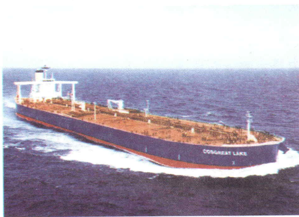
图11-5-8 庞然大物人造就——这是我国第一艘自行设计建造的超大型油轮“远大湖”号，于2002年下水。其排水量300000 t，船长333.5 m、型宽58 m、型深31 m；续航能力为3万海里；甲板面积相当于三个标准足球场，步行一圈要用十几分钟；总高度71.2 m，相当于层高2.6 m的24层大厦；船舱总容积量相当于80列15节车厢的列车。共用钢材44000 t
