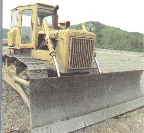
(c) 推土机的履带对地面的压强约为 3 \times 10^4 \text{ Pa}
