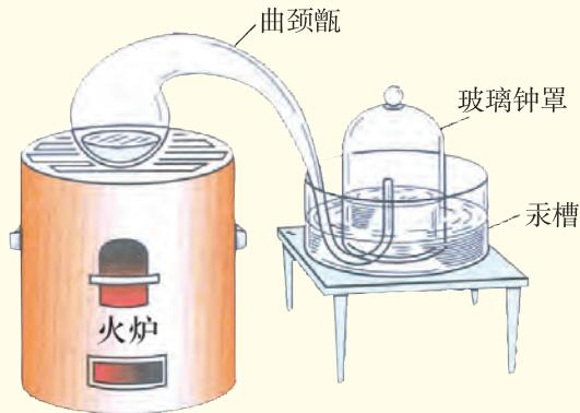
图 2-4 拉瓦锡研究空气成分所用的装置
