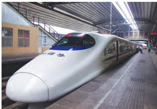
图 1-5 用特殊合金材料制造的我国“和谐号”高速列车
