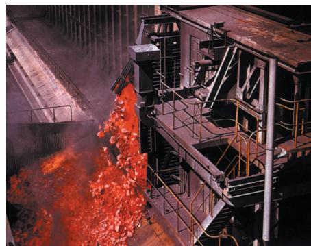
图9-5 炼焦炉
