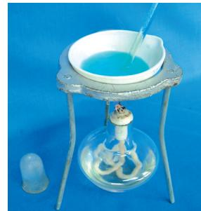
图6-18 蒸发溶剂使溶质结晶析出
