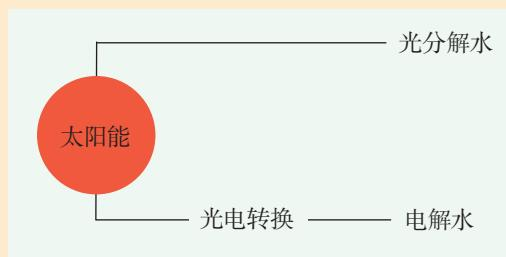
图9-10 分解水制氢气的方法
