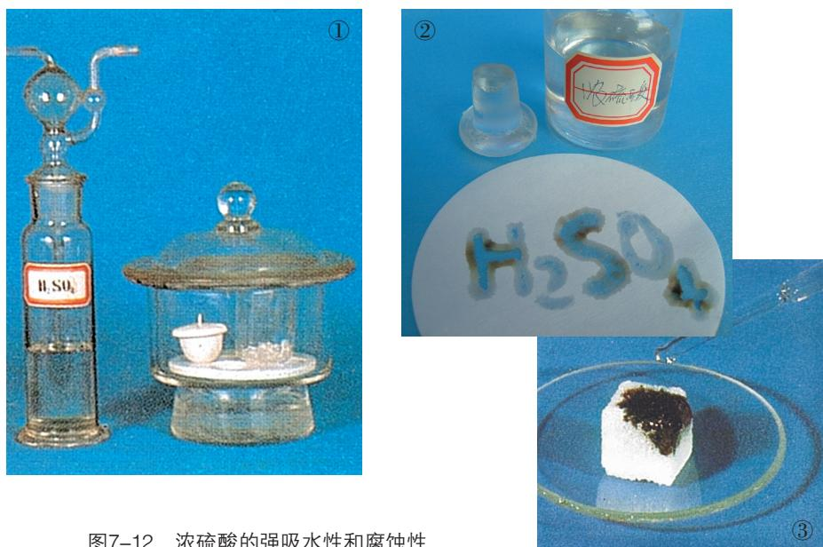
图7-12 浓硫酸的强吸水性和腐蚀性
